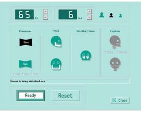
②Flash green 「READY」 icon, 「initialization of sensor」 will be displayed and CCD sensor will be initialed.
